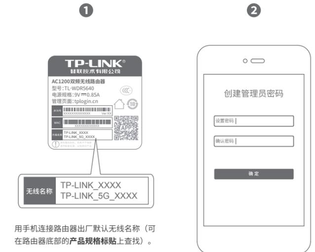
用手机连接路由器出厂默认无线名称（可在路由器底部的产品规格标贴上查找）。
